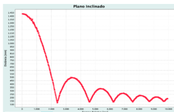
Figura 6.3 Posição em função do tempo (elab). O efeito dos ressaltos provocados pela mola não é estudado.
