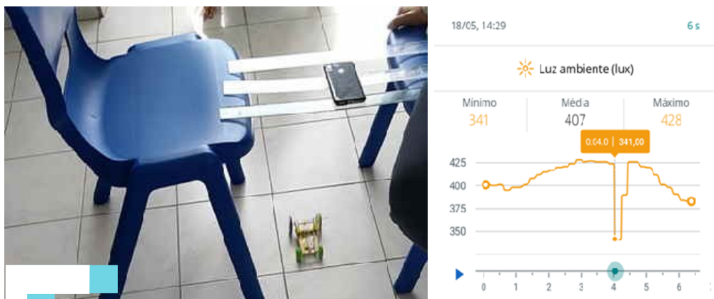
Figura 3.5 Utilização do sensor do telemóvel para medição da luminosidade respetivo registo.
